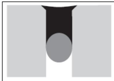
Конструкция шва заподлицо исключает помехи движению и скопления грязи.
