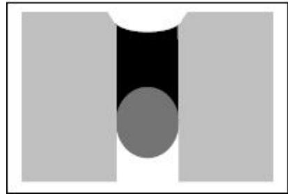
Шов с пазом защищает герметик от механических нагрузок.
