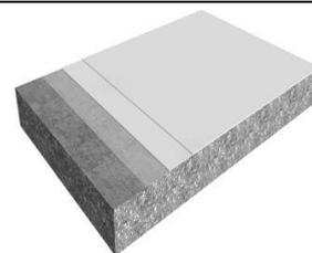
Конструкция: Sikalastic®-614 нанести в один или два слоя
